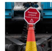
Удаляет конус и противооткатные упоры и размещает их в предназначенных для этого местах.
