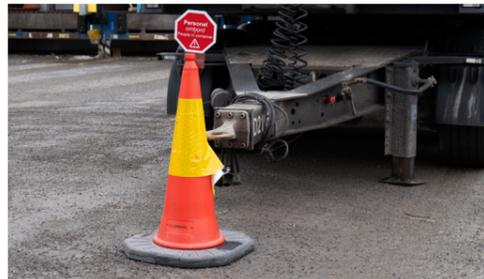
1. Запрещено заводить автомобиль до завершения погрузки или разгрузки.
